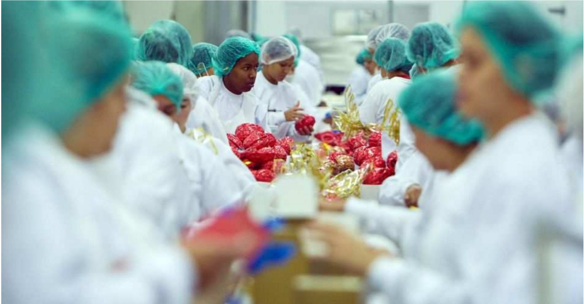
Nessa esteira, os ovos de Páscoa são montados e embalados. A temperatura da linha de produção varia entre 18°C e 22°C
