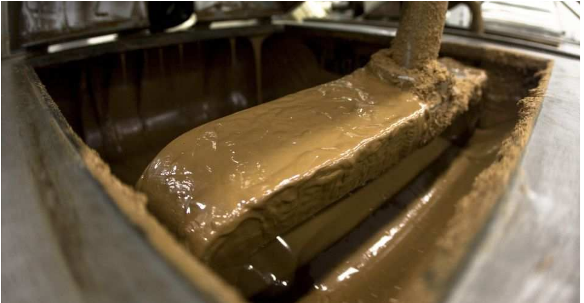
Após o refinamento, a massa de chocolate vai para uma máquina chamada concha, que mexe o produto
