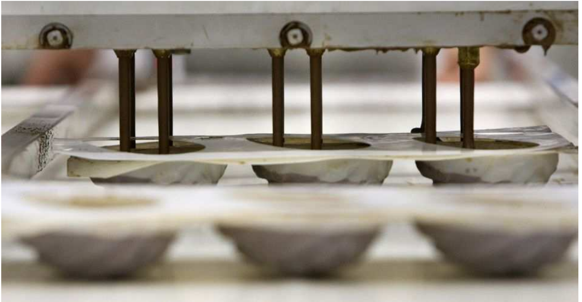
Do tanque, a massa de chocolate é levada para uma máquina que transfere a quantidade certa para as formas plásticas
